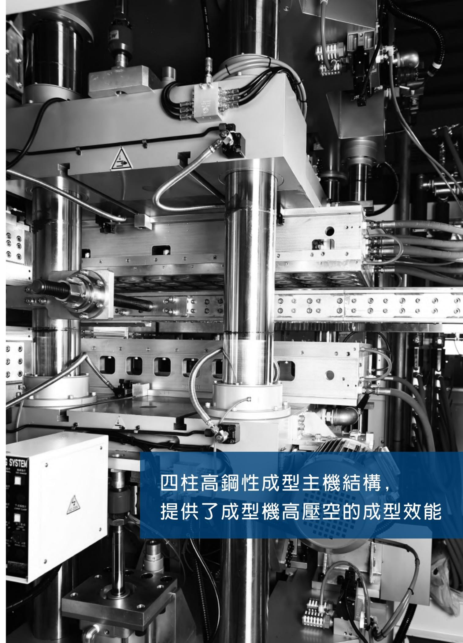
四柱高鋼性成型主機結構，
