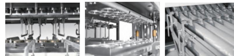
蠶霖的SL-520垂直式裁斷機融合了成熟的油壓裁斷機結構設計數據庫，與瞻望未來的創新概念。本機裁斷加工採用機械凸輪結構運作穩定順暢，整合新型控制模式，將所有生產條件數據化，可儲存生產條件設定，操作更簡單易上手，改變過去更換產品就要調整變動參數的操作方式，提高換線速度並減少廢料產生。
